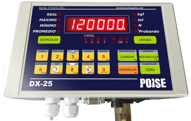
Cuenta con dos canales de entrada, cada uno con calibración independiente. La operación bipolar permite trabajar las celdas de carga en tensión y compresión con solo oprimir un botón.
